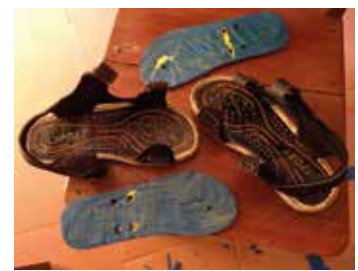
Figure 5. L'encollage des deux surfaces.
